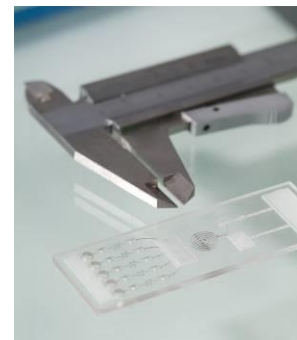
Physio Check – passives Lab-on-a-chip-System für die Diagnostik
